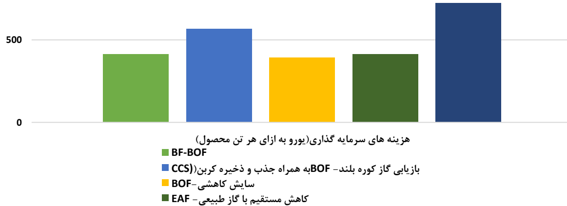
هزینه های سرمایه گذاری در تکنولوژی های مختلف فولادسازی بر پایه سنگ معدن
